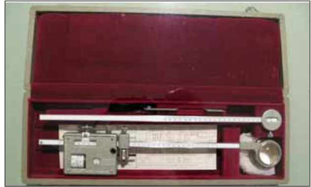
Polarplanimeter (um 1970) Durch Umfahren eines unregelmäßigen Grundstücksteils wird mit diesem Gerät die Fläche ermittelt.
