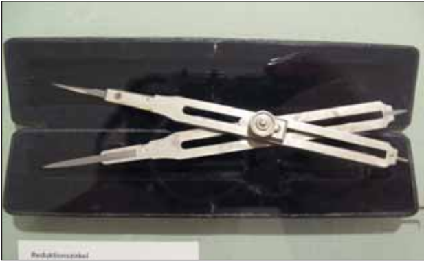
Reduktionszirkel (um 1960) Längen in verschiedenen Maßstäben können mit Hilfe des Reduktionszirkels abgegriffen werden.
