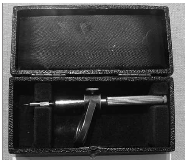
Kartiernadel (um 1970) Die genaue Auftragung von Koordinaten auf Kartonbögen wurde durch Stechen mit einer Kartiernadel ausgeführt.
